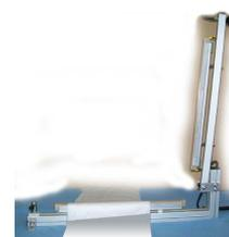
*Per giuntare le bobine su più linee, può essere comodo fissare la pinza su una struttura carrellata per poterla movimentare agevolmente e trasportarla dove necessario.*
